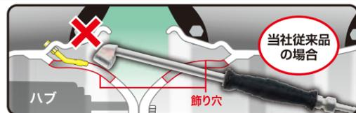
長いダクト(導管)と水平ノズルで、ISO方式ホイールの小さな穴からでもバルブにまっすぐ差し込める旭産業のISO対応タイヤゲージ。新たな時代の必需品です。
