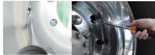
ISO 規格では PCD が大きく アルミホイールは強度を確保する なり、飾り穴が狭くなります。 為に飾り穴が小さくなります。
