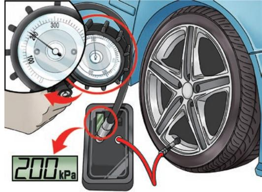
②TEST STEMを利用して、他のタイヤゲージの精度がチェックできます。
